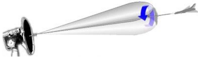
Abb 29: Bei der Minimumpeilung dreht sich das Antennendiagramm sehr schnell um eine zentrale Achse
