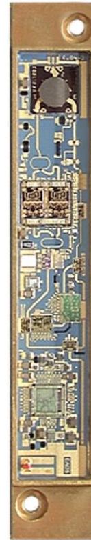
Abb. 24: Standardised Modular Transmit-/Receive-Module (SMTRM) (Mit freundlicher Genehmigung von EADS Defence & Security Ulm )
