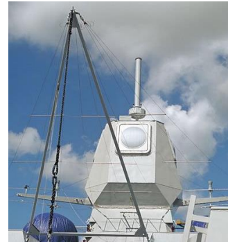
Abb. 20: Planares Array des Multifunktionsradars APAR (auf der Fregatte „Sachsen“)
