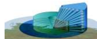
Abb. 9: Diagramm eines typischen 3D-Radargerätes, eine Kombination von schneller elektronischer Schwenkung eines Pencil- Beams und mechanischer Drehung
