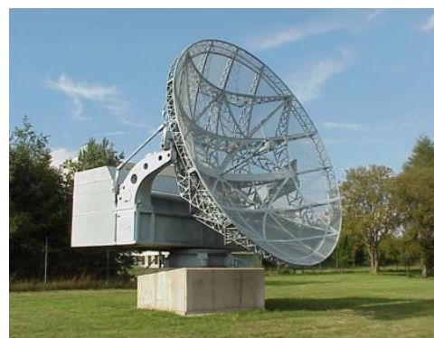
Abb. 3: Würzburg-Riese, ein deutsches Radargerät aus dem 2. Weltkrieg (Exponat in Greding auf dem Kalvarienberg)
