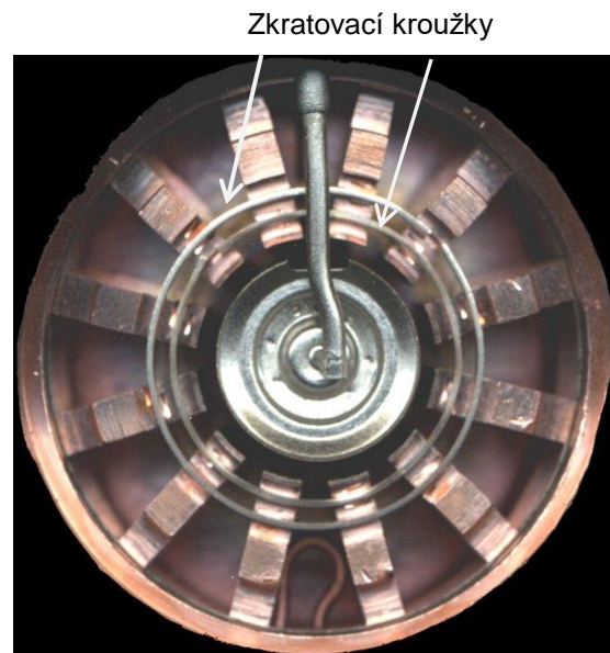
Obrázek 11: Magnetron rozříznutý, zkratovací kroužky jsou jasně viditelné
